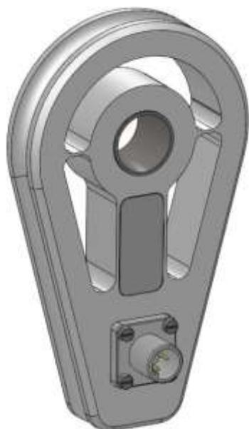
L'originalité de ce produit est de réaliser un capteur électronique en forme de cosse cœur de manière à pouvoir substituer à une cosse cœur classique. L'effort produit par le câble de traction sur la cosse produit un signal de mesure qui est proportionnel à la force exercée. Il s'installe directement sur le brin mort.
